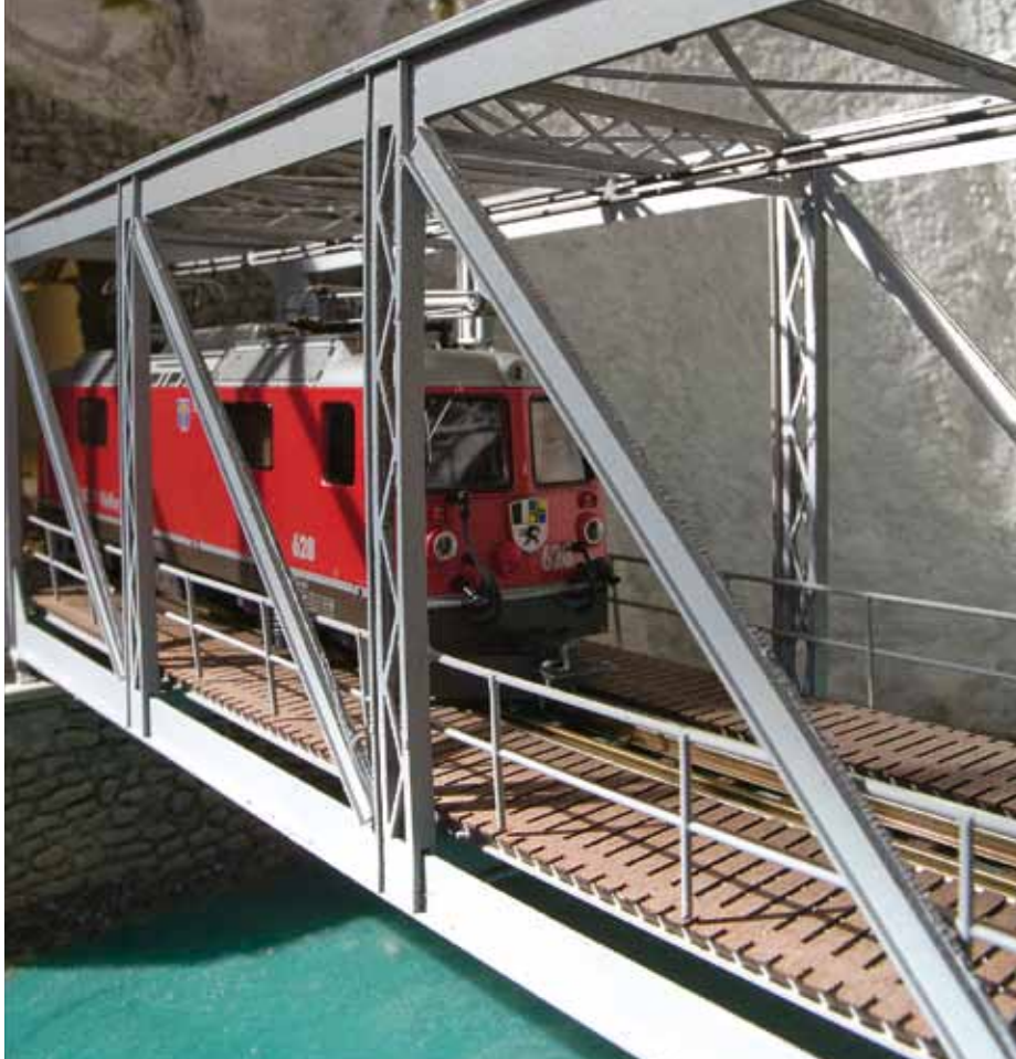
Diese Brücke besteht aus 0,4 bis 0,6 mm dickem Karton, wiegt knapp über 20 g und trägt 2,4 kg.
