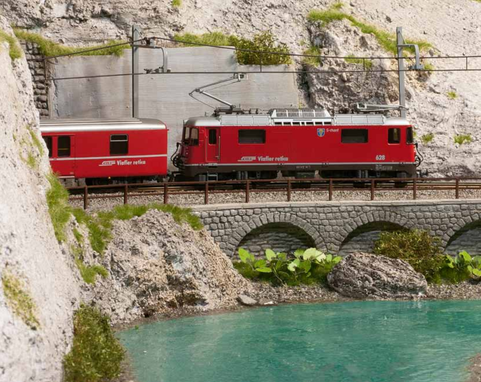
An einigen Stellen müssen sich der Vorderrhein und die Bahnstrecke den knappen Raum teilen. Die Bahn weicht mittels Lehnviadukt aus.
